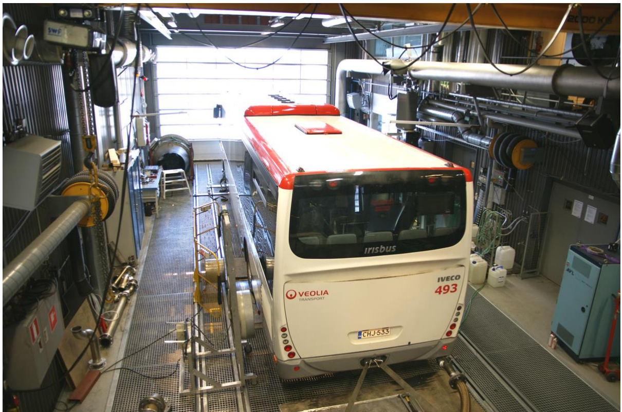
Kuva 1. Laboratorioon puhalletaan vakiolämpöistä ilmaa mahdollisimman tarkan toistettavuuden saavuttamiseksi.
